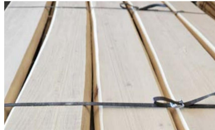
Unbesäumtes und gehobeltes Schnittholz sind gesägte und gehobelte Bretter, deren Längsseiten entrindet und geschliffen sind. Die natürliche Form der Seiten bleibt erhalten, was besonders in Gestaltungskonzepten geschätzt wird, die einen naturbelassenen Charakter betonen möchten.
