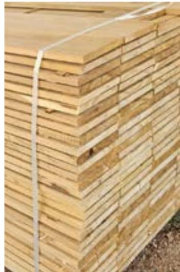
Schnittholz in Fixbreite sind beidseitig besäumte Bretter, die auf eine festgelegte Breite zugeschnitten sind. Durch diesen Bearbeitungsschritt erhalten sie eine saubere und einheitliche Kantenstruktur, was sie besonders geeignet für präzise Bau- und Fertigungsarbeiten macht, bei denen genaue Maße erforderlich sind.
