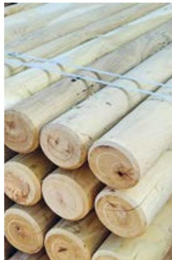
Durch die Fräsung werden Robinien-Palisaden in ihrer natürlichen Wuchsform begradigt. Die so bearbeiteten Palisaden können dicht an dicht aneinandergereiht werden.
