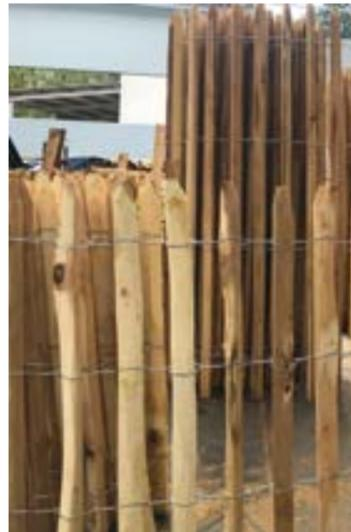
Wir fertigen unsere Staketten für die Robinio-Rollzäune auf zwei verschiedene Arten: Durch Sägen und Schleifen, was ein sehr gleichmäßiges Zaunbild ergibt und alternativ durch Spalten entlang der Fasern, wodurch die natürliche Unregelmäßigkeit des Holzes betont wird.
