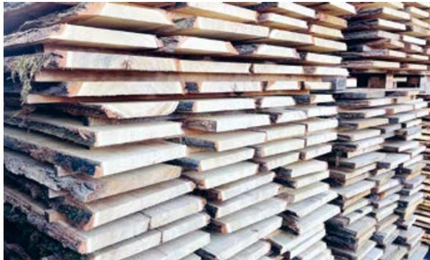
Unbesäumtes Schnittholz sind gesägte Bretter, bei denen die Längsseiten nicht bearbeitet sind, so dass die Rinde erhalten bleibt.
