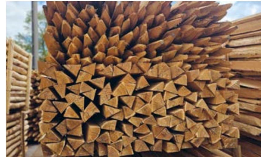
Unsere gespitzten Spaltpfähle werden geschält, der Länge nach in mehrere Spalten gesägt, alternativ entlang der natürlichen Fasern gespalten. Durch diese Bearbeitung erhalten die Pfähle zwei gerade Kanten.
