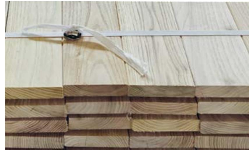
Gehobeltes Schnittholz in Fixbreite sind beidseitig besäumte Bretter, auf eine festgelegte Breite zugeschnitten, 4-seitig gehobelt und an den Kanten gefast.
