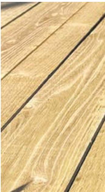
Schnittholz in fallender Breite sind beidseitig besäumte Bretter, bei denen die Breite nicht einheitlich, sondern entsprechend der natürlichen Dimensionen des Stammes variabel ist.
